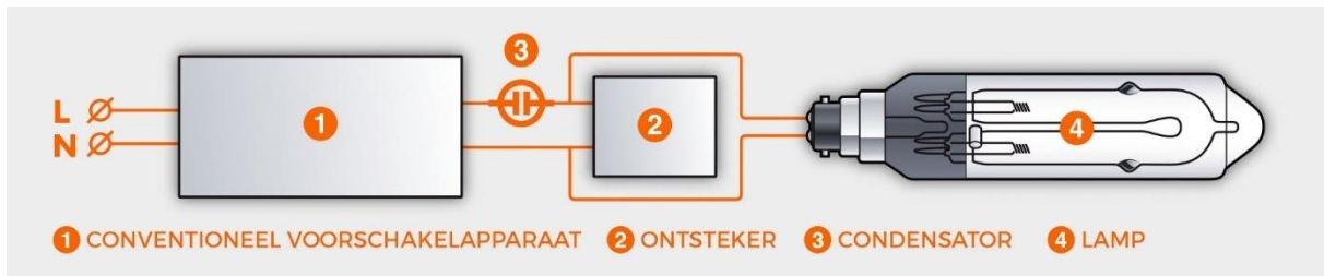
Figuur 108: Aansluitingsschema voor SOX lamp met C-VSA
