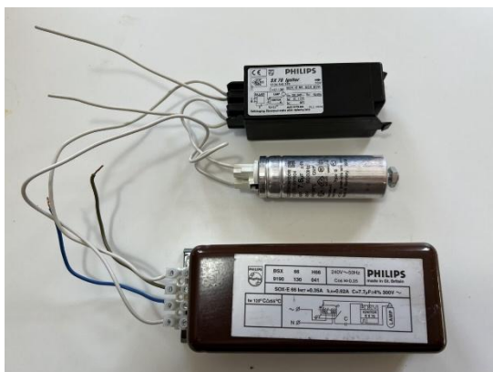
Figuur 111: Ontsteker (boven), Condensator (midden) en C-VSA (onder)
